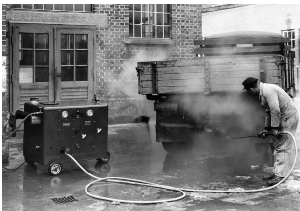
Het eerste reinigungsapparaat van Kärcher: de eerste Europese KW 350 warmwater hogedrukreiniger uit 1950.
