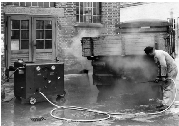
Le tout premier appareil de nettoyage Kärcher : le premier nettoyeur haute pression à eau chaude européen KW 350 datant de 1950.
