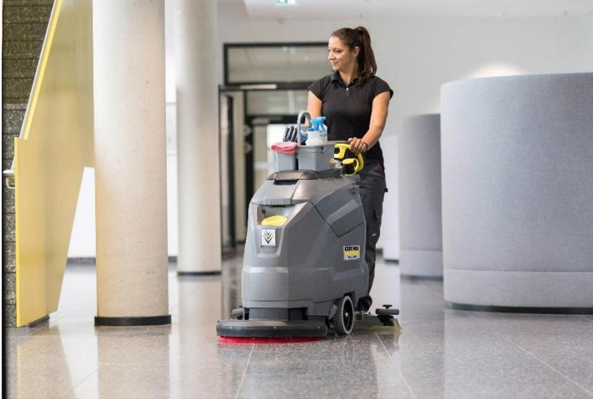
*Kärcher étend en outre dans un premier temps l'utilisation de ses batteries lithium-ion modernes (80 Ah) à cinq modèles d'autolaveuses aspirantes autoportées et autotractées.*
