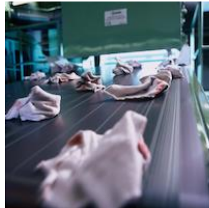
De doeken worden in een geautomatiseerde wasstraat gewassen (Foto: MEWA)
